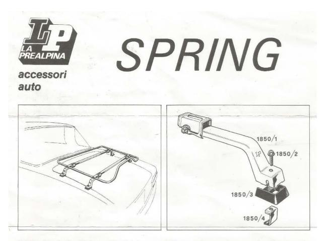
Portabagaglio applicabile sui bauli posteriori delle vetture. Trasformabile in portasci. Costruito in due versioni: in acciaio INOX ed in acciaio plastificato, con traverse portanti sezione 25 x 15. Larghezza regolabile.
