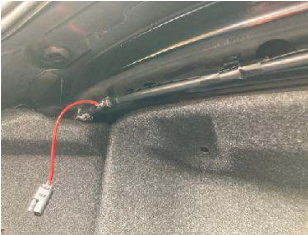
Verbinden Sie die Verkabelung wieder mit der Buchse auf der linken Seite und Sie haben einen Stecker, mit dem Sie jederzeit auch das dritte Bremslicht anschließen können.
