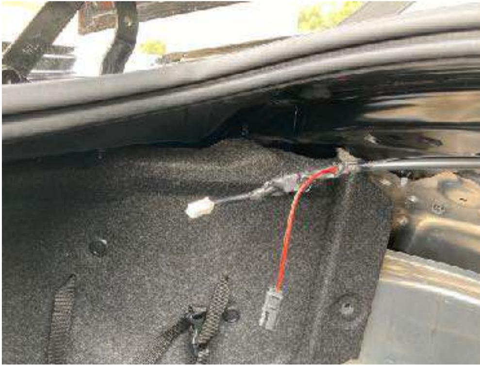
Schließen Sie die Abzweigung über die Klemmleiste an und wickeln Sie die Verbindung dann mit Isolierband ein.
