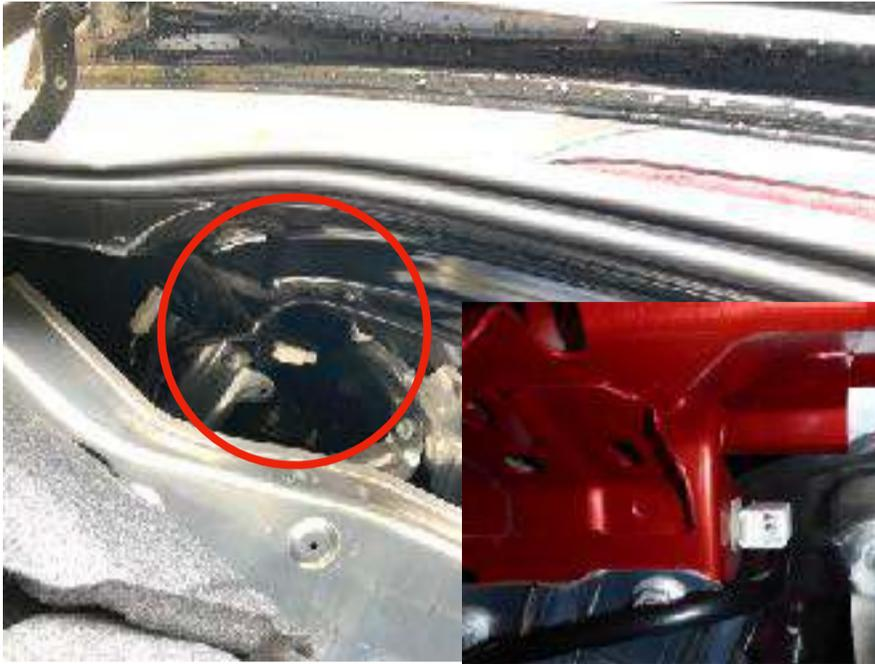
Das dritte Bremslicht eines MX5 ND wird an einem Stecker oben hinten links am Kofferraum befestigt. Der Teppich auf der linken Seite muss weggezogen werden, um ihn freizulegen
