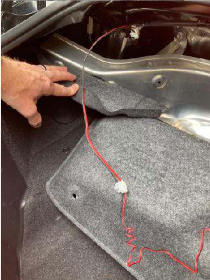
Wir schlagen vor, dass Sie den Draht vorsichtig abschneiden und mit einem Klemmenblock einen Abzweig herstellen, der das ursprüngliche Kabel wieder mit zwei zusätzlichen Drähten auf einer Seite des Klemmenblocks verbindet.
