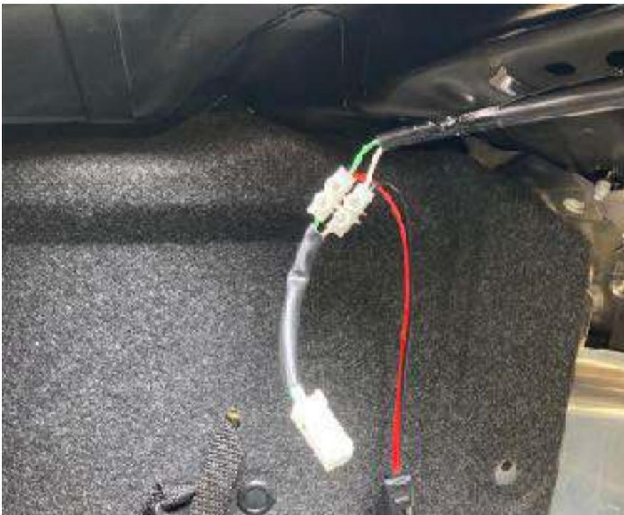
Stecker abziehen. Sie können das Kabel sehen, das an der Rückseite des Kofferraums bis zur Leuchte an der Rückseite des Kofferraumdeckels verläuft.
