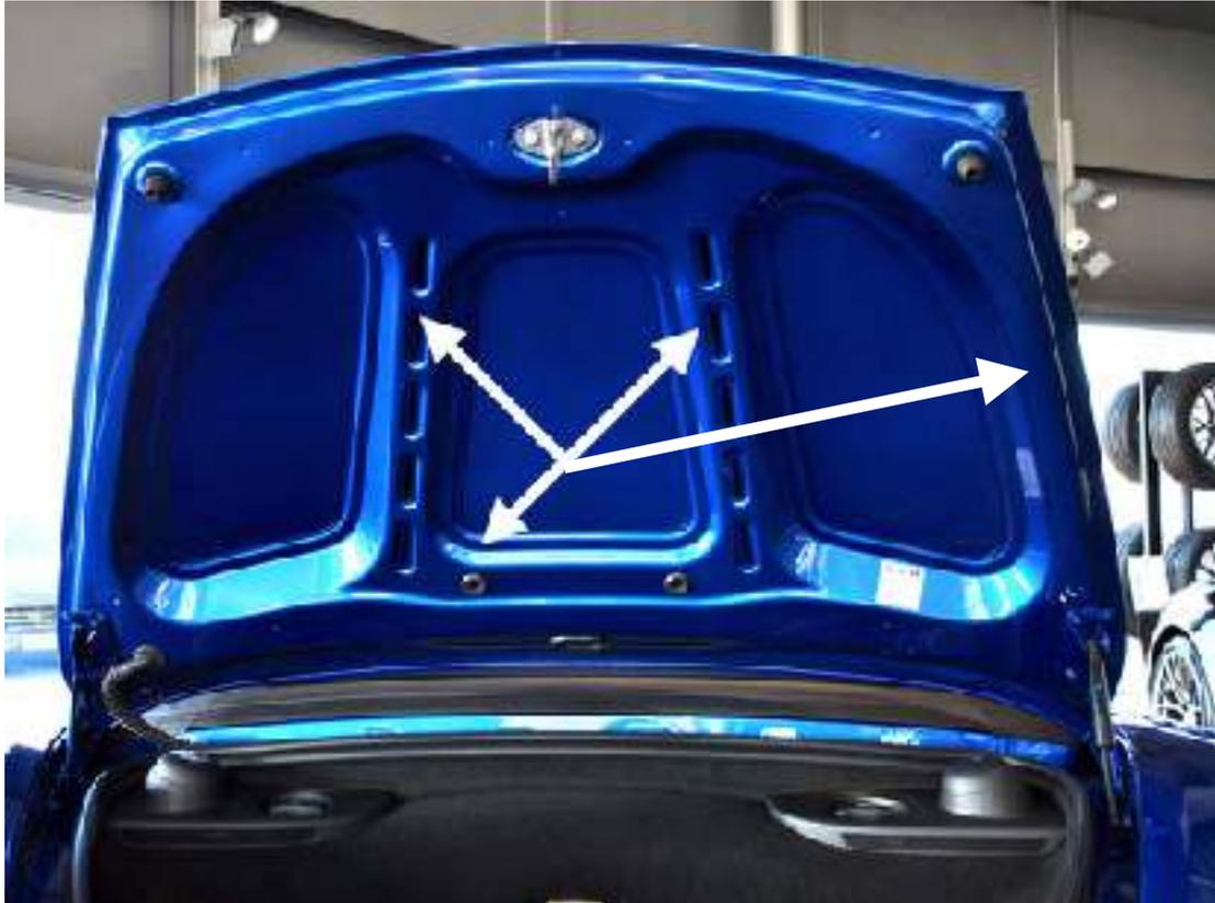
3. Asegúrese de limpiar la base de la copa y el área donde se colocará la copa en el maletero/tapa del maletero con un paño húmedo antes de colocarlo. Esto protege la pintura y detiene las fugas de aire. Presione la rejilla sobre cada taza y bombee el aire de las tazas con el émbolo. La línea roja desaparecerá cuando la copa esté completamente comprimida. Es posible que deba presionar firmemente para asegurar la copa.
