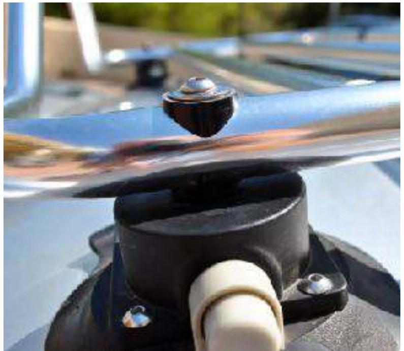
No apriete completamente el perno; asegúrese de que la ventosa pueda girar libremente en el marco antes de colocar el bastidor en su automóvil. Esto permite que las copas giren en el marco para adaptarse a la curva de la tapa de la cubierta / cubierta de su automóvil.
