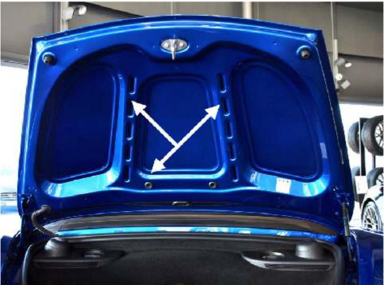
3. Stellen Sie sicher, dass Sie die Becherbasis und den Bereich, an dem der Becher befestigt wird, am Kofferraumdeckel mit einem feuchten Tuch abwischen, bevor Sie ihn anbringen. Dies schützt die Farbe und stoppt das Austreten von Luft. Drücken Sie auf das Gestell über jedem Becher und pumpen Sie die Luft mit dem Kolben aus den Saugnäpfen.
