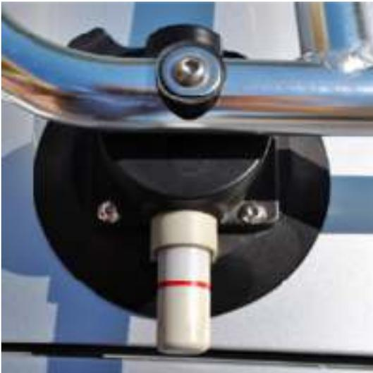
4. Wenn ein Saugnapf vollständig komprimiert ist, verschwindet die rote Linie wie unten dargestellt. Ziehen Sie nun die Schrauben fest an und stellen Sie sicher, dass sie fest am Rack anliegen (sie anfangs locker zu lassen, ermöglicht den Saugnapfen, sich der Form Ihres Kofferraumdeckels / Ihrer Heckklappe anzupassen, um gute Kompression zu gewährleisten).
