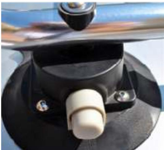
5. Sie müssen sicherstellen, dass alle Saugnäpfe sicher sitzen und komprimiert bleiben. Wir empfehlen, nach 10-15 Kilometern Fahrt mit einem beladenen Rack anzuhalten und die Saugnäpfe zu überprüfen. Es ist leicht zu sehen, ob sie undicht und nicht komprimiert sind, da die rote Linie auf dem Kolben sichtbar wird. Die Saugnäpfe sind nicht dazu gedacht, dauerhaft an Ihrem Auto befestigt zu sein. Sie werden das Vakuum im Laufe der Zeit langsam verlieren.
